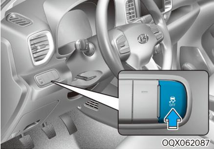
차체자세 제어 장치(ESC)는 미끄러지기 쉬운 노면에서 구동되는 바퀴가 헛도는 것을 방지하여 발진하기 쉽게 하고 선회 가속할 때 적절한 구동력, 조종력을 확보하는 기능 뿐만 아니라, 차속 및 조향각 센서 등 각종 센서들로부터 운전자의 조종 의도를 판단하고 4개의 바퀴에 개별적인 제동력을 적절히 배분하여 제동시 및 가속시, 또한 커브를 돌 때 차량의 앞,뒤,좌,우 모든 방향에 대한 차체의 자세를 제어하여 보다 안정된 조종력을 확보하기 위한 장치입니다.
