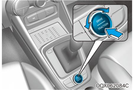
「DRIVE/TRACTION」모드 버튼을 누르면 드라이브 모드에서 구동력 제어 모드로 변경이 됩니다. 4초 이내에 구동력 제어 모드 노브를 회전하여 SNOW/MUD/SAND 모드를 선택할 수 있습니다. 다시 「DRIVE/TRACTION」모드 버튼을 누르면 기존 선택된 드라이브 모드로 변경이 됩니다.
